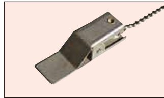
MODEL-225 细金属线等小负荷试验用夹具
